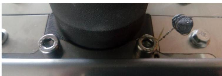
Рисунок 2а – Пломбировка основной маркировочной таблички пломбой завода-изготовителя
