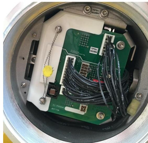
Рисунок 2в – Место установки пломбы, несущей знак поверки – пломбировка аппаратной защиты на материнской плате.
