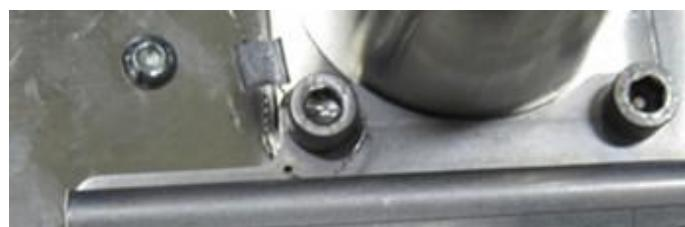
Рисунок 2а – Пломбировка основной маркировочной таблички пломбой завода-изготовителя
