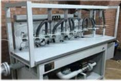
Поверочное и испытательное оборудование предназначено для применения в процессе проверки и поверки счетчиков/расходомеров газа и электронных корректоров объема газа. Оборудование может быть востребовано в организациях, занимающихся сервисным обслуживанием, ремонтом и/или поверкой данных приборов.
