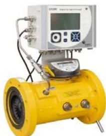
Комплексы для измерения количества газа СГ-ТК (с температурным корректором ТС220) и СГ-ЭК (с корректорами объема газа ЕК270 и ЕК280) предназначены для измерения объема неагрессивного сухого газа, приведенного к стандартным условиям путем измерения объема газа при рабочих условиях счетчиками газа турбинными (TRZ, СГ) или ротационными (RABO, RVG) и автоматической электронной коррекции корректорами объема газа.
